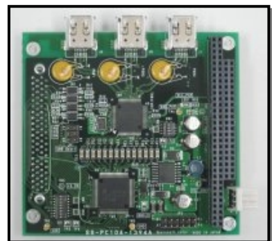
PC/104 LINK/PHY【SS-PC104-1394A】 6pinのIEEE1394ポートを3つ搭載
